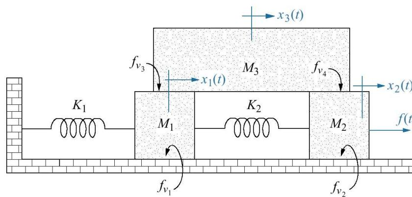
Yukarıdaki mekaniksel sistemin hareket denklemlerini yazınız.
