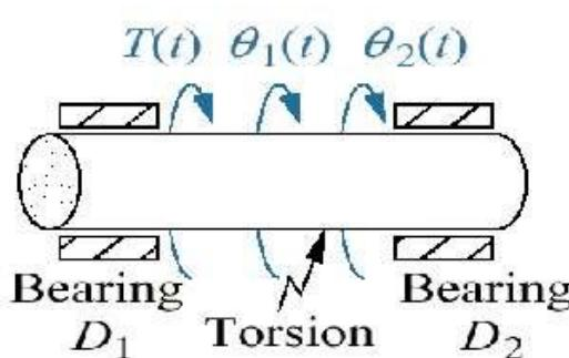
Sistemin,  $\theta_2(s)/T(s)$  transfer fonksiyonunu yazınız. Çubuk her iki taraftan yataklanmıştır ve burulmaya maruz kalmaktadır. Sağ tarafa tork uygulanırken yer değiştirme sol taraftan ölçülmektedir.
