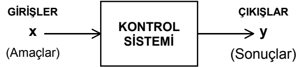
Şekil 1-1 Bir Otomatik Kontrol Sisteminin Blok Diyagramı
